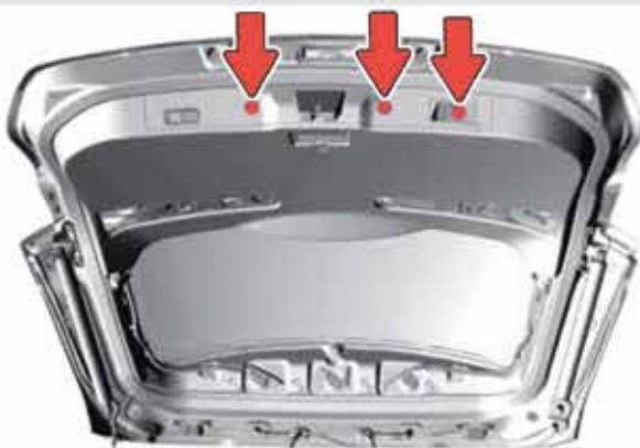
**4** Открутите пять саморезов крепления нижней обивки двери багажного отделения. Снимите нижнюю обивку двери, отстегнув клипсы.
