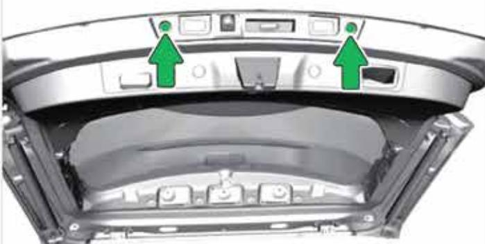
**6** Отсоедините четыре разъема и снимите наружную накладку двери багажного отделения.
